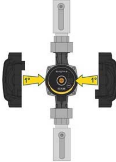
Resim 7: Pompa gövdesinin yalıtımı
